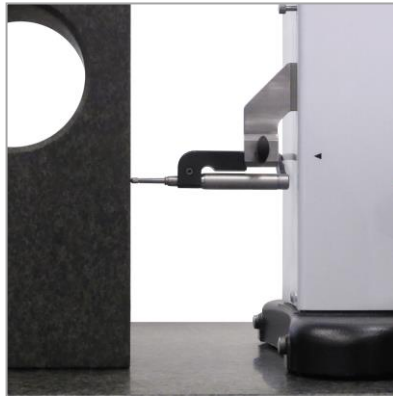
Pomiar prostokątności z użyciem sondy indukcyjnej
