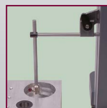
Pomiar rowków wewnętrznych
