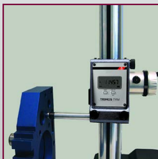
Pomiar odległości osi
