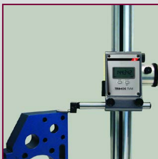
Pomiar wysokości i głębokości
